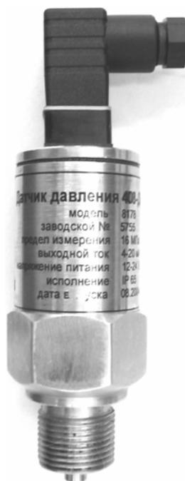
Рисунок 2 - экспериментальный образец датчика давления.
