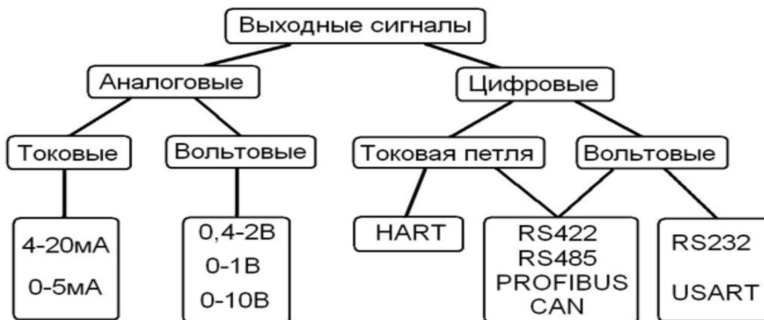
Рис. 1 – выходные сигналы датчиков.
