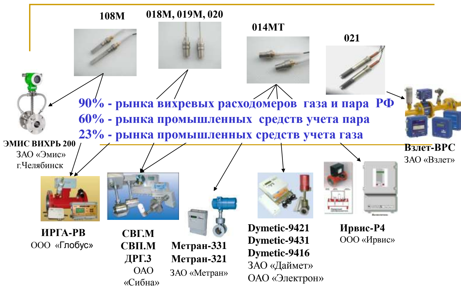
Рис.1. Пьезоэлектрические датчики и вихревые расходомеры газа и пара на их основе
