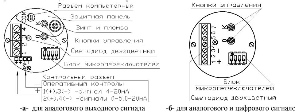
Рисунок 3 – Схемы монтажных плат с элементами регулировок датчиков моделей 8XX1÷8XX7
