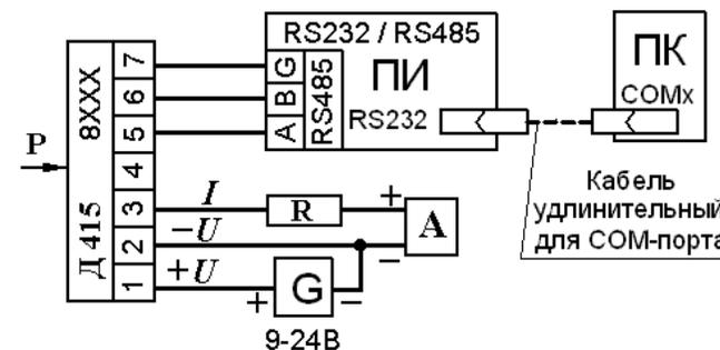
**Рисунок Б.8** – Схема включения датчиков
